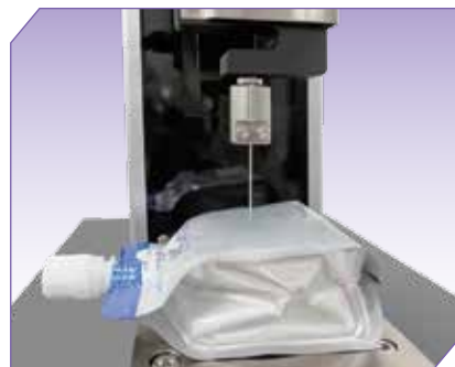
Испытание упаковочной тары на отслаивание
